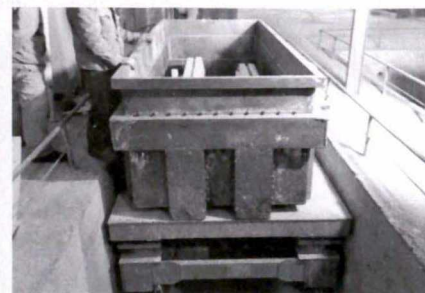
图 10 行走震实台 Fig.10 Movable vibration compaction table
