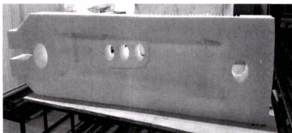
图 2 曲柄泡沫型平台面 Fig.2 Platform plane of crank foam pattern
