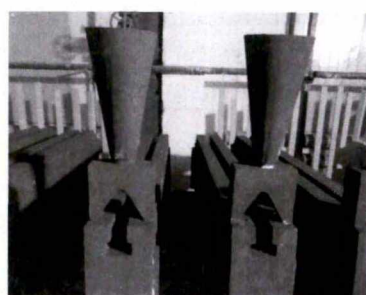
图 32 调整后的浇注系统 Fig.32 Adjusted pouring system
