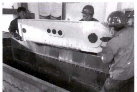
图 8 放置泡沫型 Fig.8 Place foam pattern in sand box
