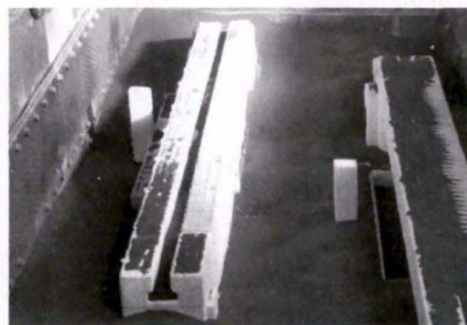
图 9 加砂固定模型 Fig.9 Add sand to fix foam pattern
