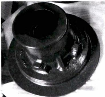
图 11 QT550-6 壳体合格铸件实物
