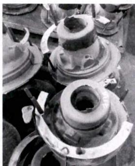
图9 增加气眼针后的铸件
