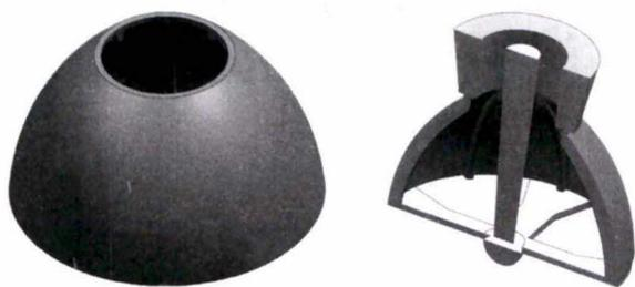
(a)试验模型 (b)浇注工艺设计剖视图
