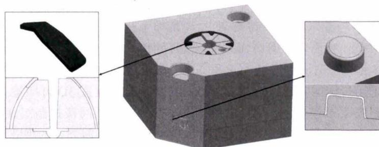
图 3 3D 打印检具直接定位原理图
