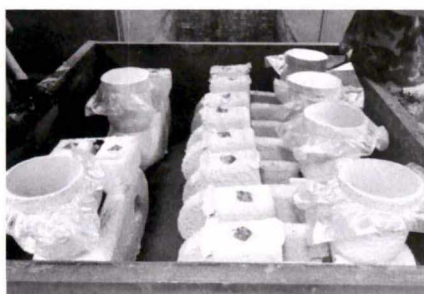
图 27 横 4 顺 2,每箱摆 6 件模型 Fig.27 Place the shell molds in box
