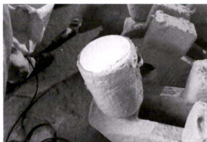
图 12 暴露浇冒口作排胶口
