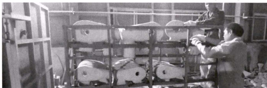
图 15 泡沫型装上窑车准备入窑
