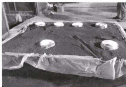
图 31 3 次出钢液浇一箱,确保浇注温度 Fig.31 Pouring steel liquid
