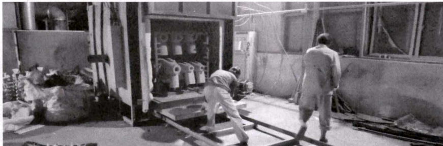
图 20 取出胶板后迅速将窑车入窑,继续升温焙烧
