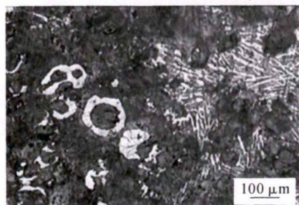
图6 球墨铸铁反白口
