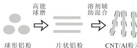
图1 片状粉末-溶剂辅助混合法获得CNT/Al复合材料粉末示意图
