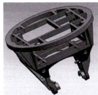
图 1 雷达天线底座三维模型
