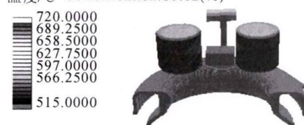
(b)工艺优化后80%凝固过程温度场分布图
