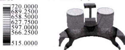
(a)工艺优化后30%凝固过程温度场分布图
