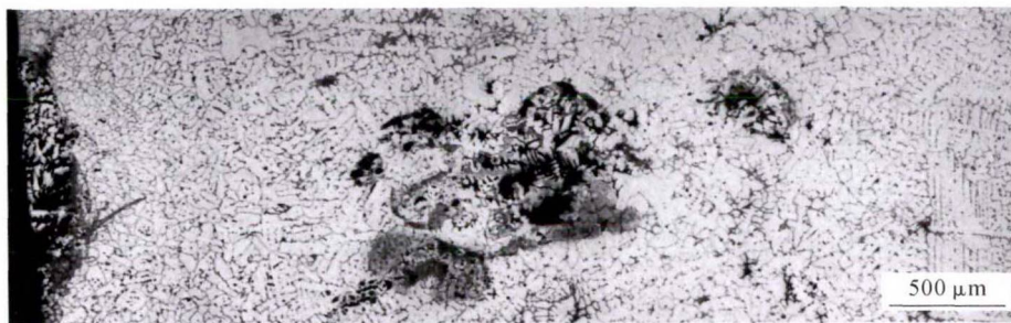
图 7 HK40 合金辐射管弯头中的典型缺陷组织 Fig.7 Typical defect in HK40 alloy radiant tube elbow
