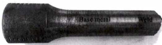
图7 拉伸试棒断裂位置 Fig.7 Tensile test bar broken position
