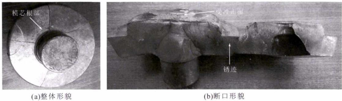
图 1 H13 模芯断裂后宏观图
