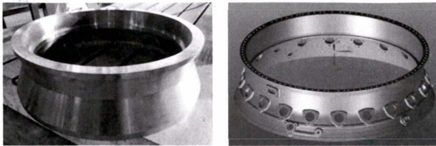
图1 涡轮外机匣锻件及零件结构
