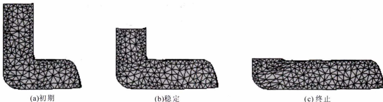
图5 304 不锈钢等径角挤压变形过程
