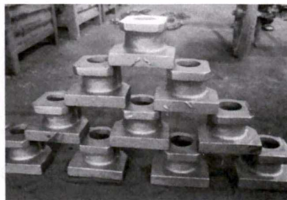
图 24 清理后的铸件簇
