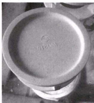
图 29 泵座泡沫型 Fig.29 Lost foam pattern
