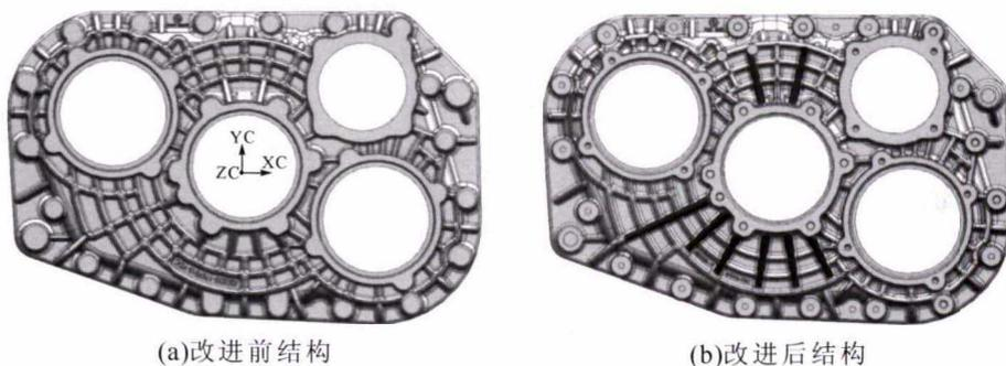
图 7 后盖压铸件改进前后结构对比
