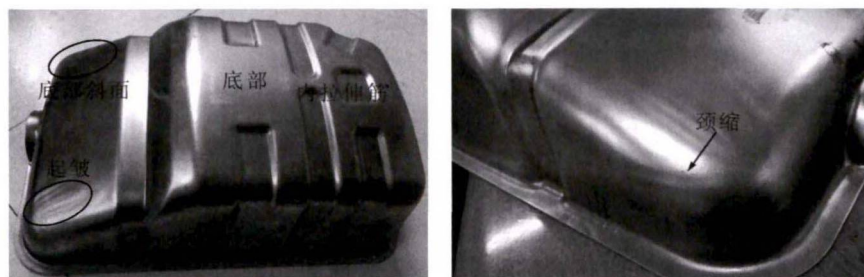
图1 覆盖件起皱和塑性失稳缺陷
