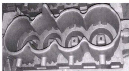
(a) 原涂料浸涂砂芯状态
