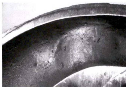
(a)内腔皱皮、氧化皮、气孔缺陷
