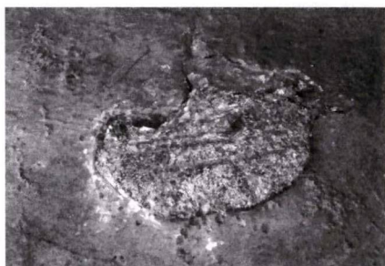
图4 铜合金螺旋桨的机械粘砂缺陷
