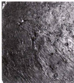
图3 铜合金螺旋桨的冷隔缺陷
