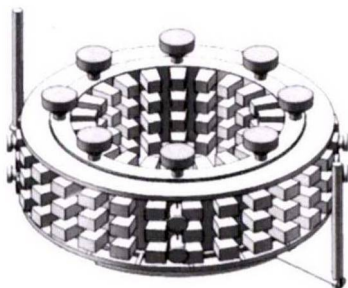
图2 环形铸件浇注系统、冒口及冷铁分布示意图
