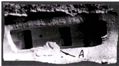
图10 型腔中的毛刺 Fig.10 Burrs in the mold cavity
