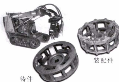
图6 建筑和园林用装载机 ADI 驱动轮
