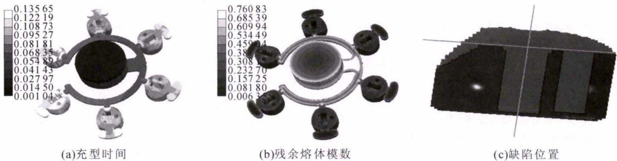
图4 最佳工艺参数下铸件充型过程的模拟仿真
