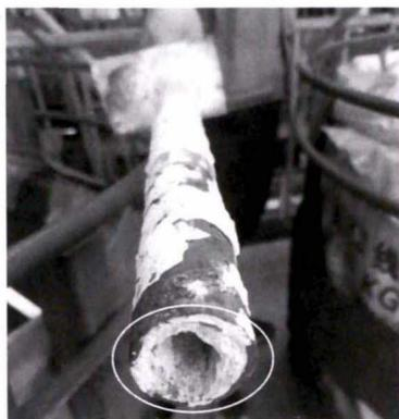
图9 导管内壁结渣
