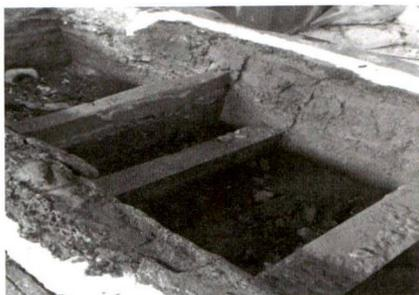
图5 浇包浇筑耐火材料工作面深裂纹
