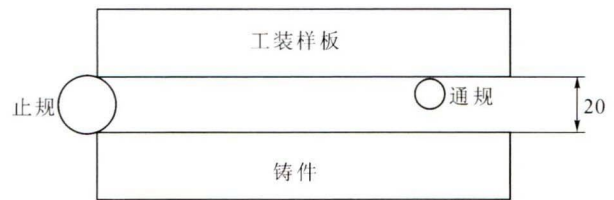
图 5 通止规使用原理 Fig.5 Operation principle of Go and No-Go gauges
