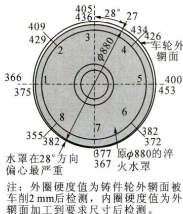
图 5 车轮表面硬度与淬火水罩位置偏差的关系
