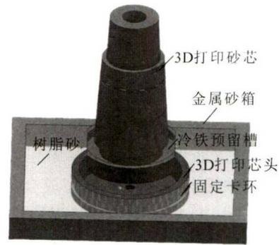
图3 双造型材料复合造型技术示意图
