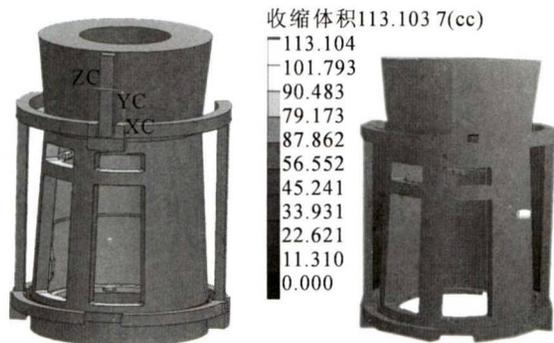
图2 铸件的浇注系统(左)和缩孔缩松模拟结果(右)
