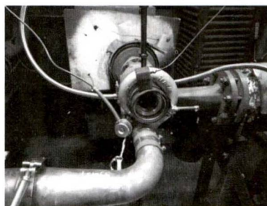
图 7 装配好的涡轮增压器样件准备进行台架实验
