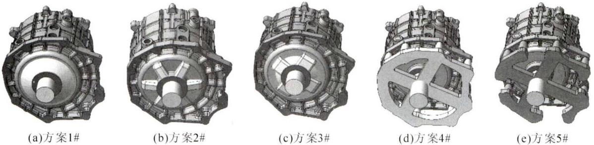
图9 低压铸造浇道优化设计
