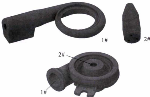
图3 砂芯形状、安放位置 Fig.3 Shape and placement of sand core
