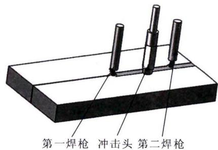
图2 冲击跟踪焊(ITW)示意图
