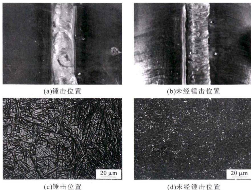
图6 NB 钢RITW的焊缝宏观和微观组织<sup>[32]</sup>
