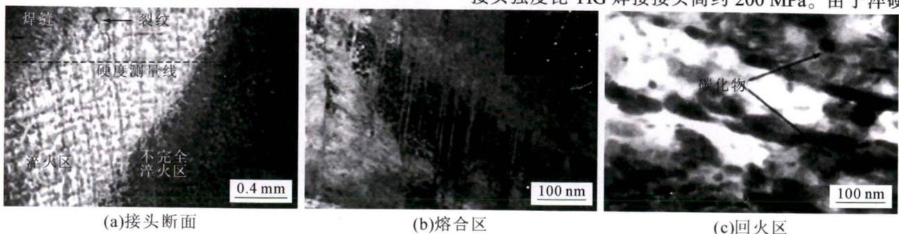
图4 NB钢TIG焊接接头的微观组织<sup>[19]</sup>
