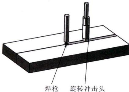
图1 旋转冲击跟踪焊(RITW)示意图
