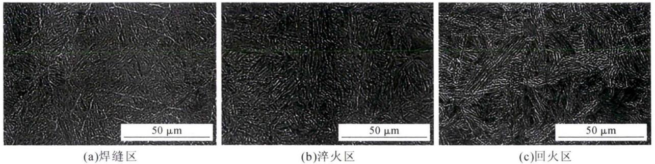
图5 NB 钢激光焊接接头的微观组织<sup>[29]</sup>
