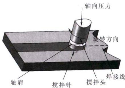
图3 搅拌摩擦焊(FSW)示意图
