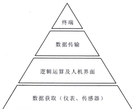
图 3 数据处理方式结构分层
