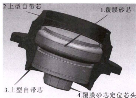
图 5 轮毂砂芯设计简图
