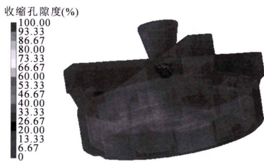
图6 预测的导叶铸件疏松缺陷
