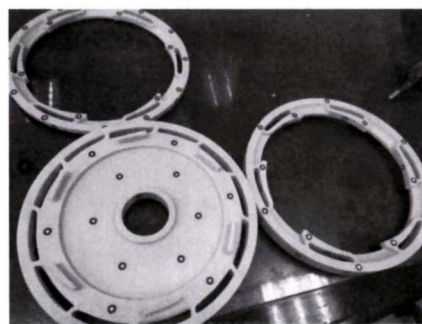
图 1 由于生产导叶铸件的 3 个蜡模
