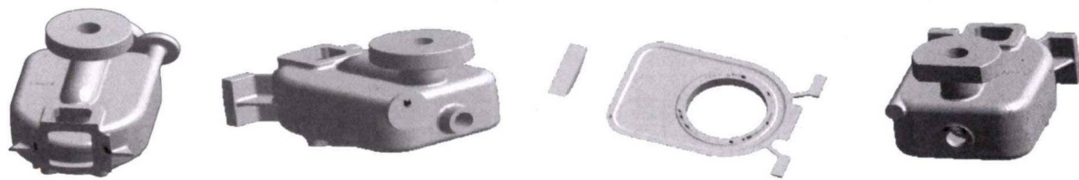
图 11 模拟结果切片显示缺陷位置 Fig. 11 Slices of simulation show shrinkage defects
