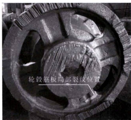
图1 轮毂裂纹部位
