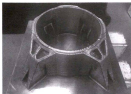
图8 增材打印的 TC4 连接箱体试验件
