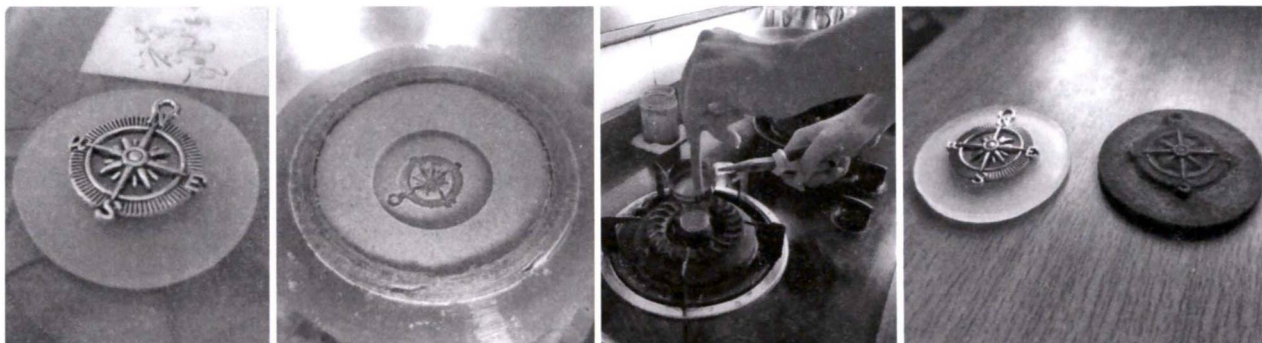
图1 学生利用太空砂、火漆蜡等材料物理模拟砂型铸造过程
