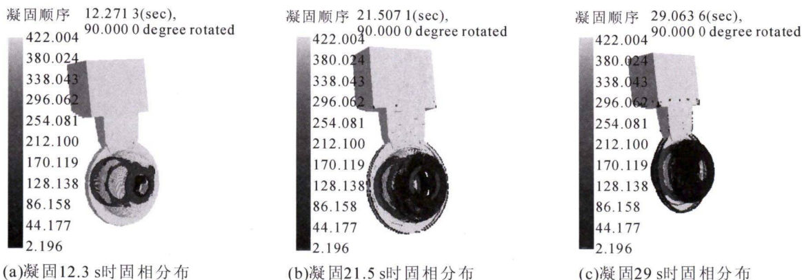
图 5 不同时刻铸件内部固相分布图 Fig.5 Solid phase distribution diagram at different solidification time points
