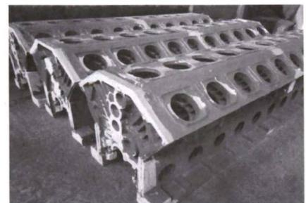
图 7 实际生产的缸体铸件
