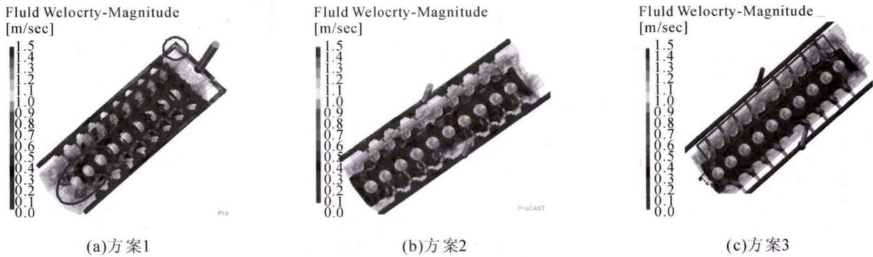
图 4 3 种方案的充型速度(初始充型)
