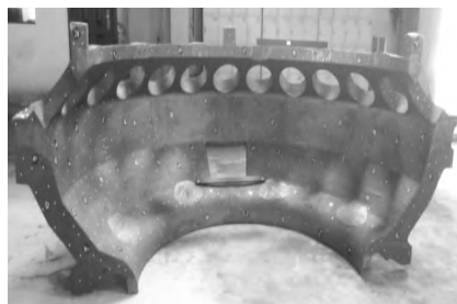
图8 燃烧室外壳铸件实物图
