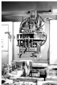
图 8 铝合金缸盖铸造(下芯,宝珠砂无机粘结剂砂芯)
