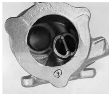
图3 涡轮增压器壳体铸件
