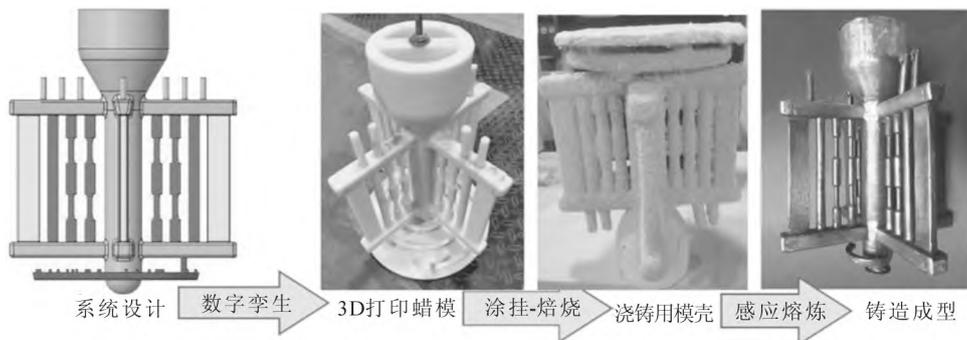
图 3 高通量流动性螺旋样品和标准机械样品的数字孪生制造过程:从数字设计到 3D 蜡模打印、陶瓷模具制作、感应熔炼到最终铸造样品
