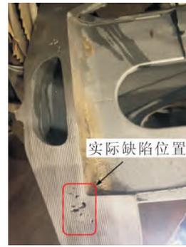
图 6 铸件实际缺陷位置
