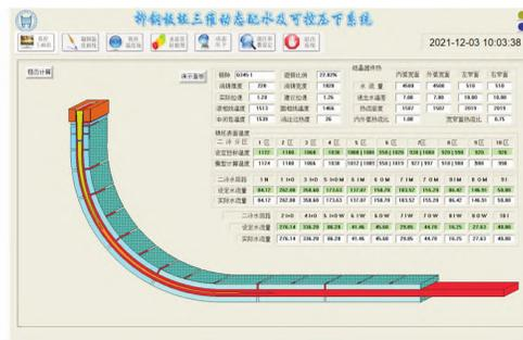
图 10 三维二冷动态配水系统<sup>[38]</sup>
