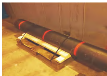
图 1 喷射成形高速钢材质毛坯锭( \phi 300 mm)
