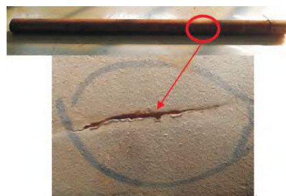
图 2 失效套管宏观形貌
