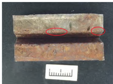
图7 断口宏观形貌
