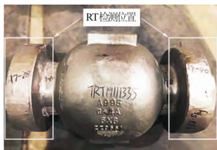
图 8 射线探伤阀体 Fig.8 RT test valve body
