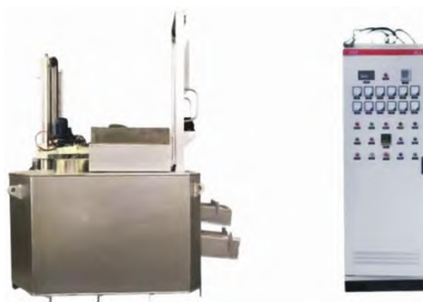
图4 1 t内加热压铸铝熔化保温设备样机
